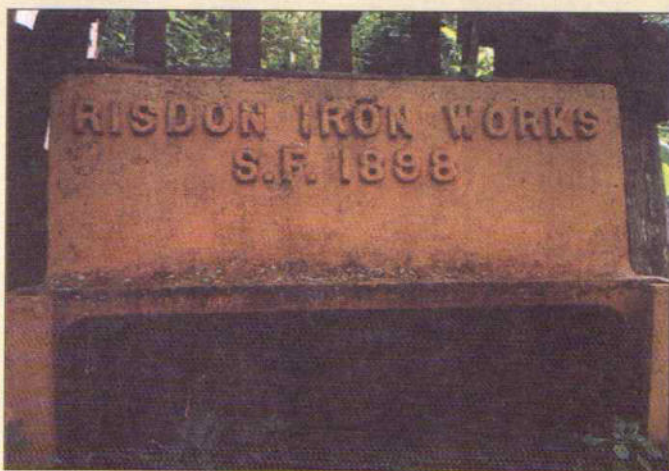
Maquinaria de minería, abandonada en minas de Los Tornos a 5 Km. de Santa Elena, Traída de San Francisco, California. Base donde se molía con mazos el material
