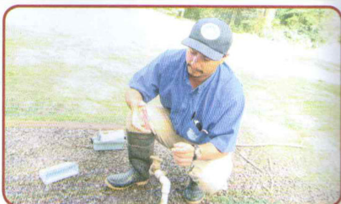
Pruebas de cloro residual
