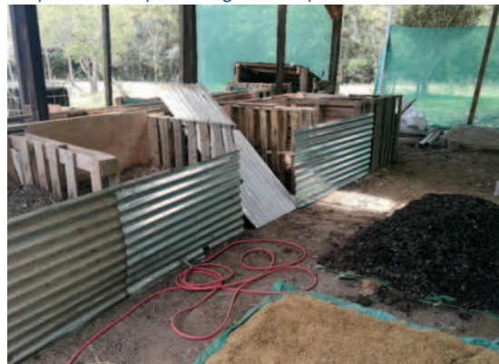
El primer prototipo del reactor de compostaje tipo "pilas estáticas con airación forzada"
