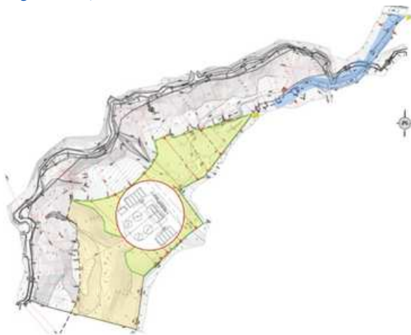
Figura 5. Prueba de compatibilidad entre el espacio construible y las dimensiones de la planta elegida (Nota: El diseño final debe de ser más lineal para respetar los retiros internos al lado este. Fuente: Elaboración propia).
